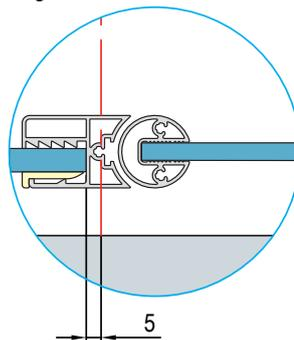
Ce type de montage est équipé d'un profilé de compensation murale réglable de -17 à +8 mm. Dans le cas où votre cote ne figure pas dans le tableau ci-dessus, une fabrication sur-mesure sera nécessaire.
