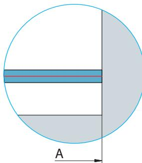
Ce type de montage est équipé d'un profilé de compensation murale réglable de -18 à +7 mm.
